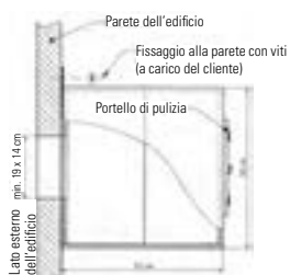
▲ Sezione della cassetta montata
